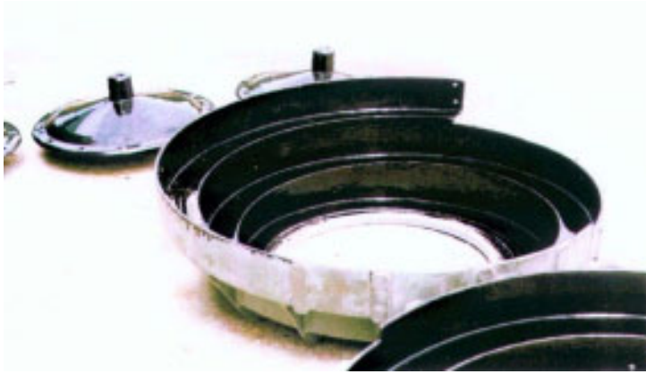
Vue du carter après son traitement au pinceau du « Flexi-Tech 60 FG »
